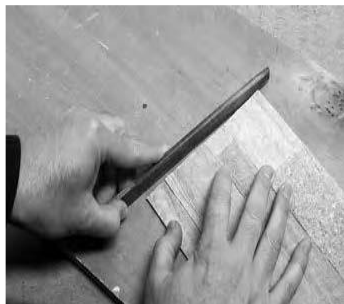
Vhodná poloha pilníku při broušení.
