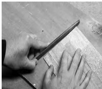
Vhodná poloha pilníku při broušení.
